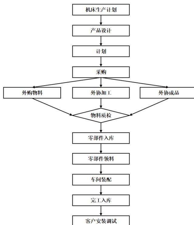
中捷航空航天产品定制化程度较高，可满足不同客户的特定需求。中捷航空航天主要进行产品技术及生产工艺的设计开发以及整机装配，基本生产方式为：以销定产，根据用户需求进行产品设计和开发，编制工艺路线，结合交付计划进行采购，采购的物料质检后入库，车间向库房领料后，根据工艺流程进行后续装配、调试等。
